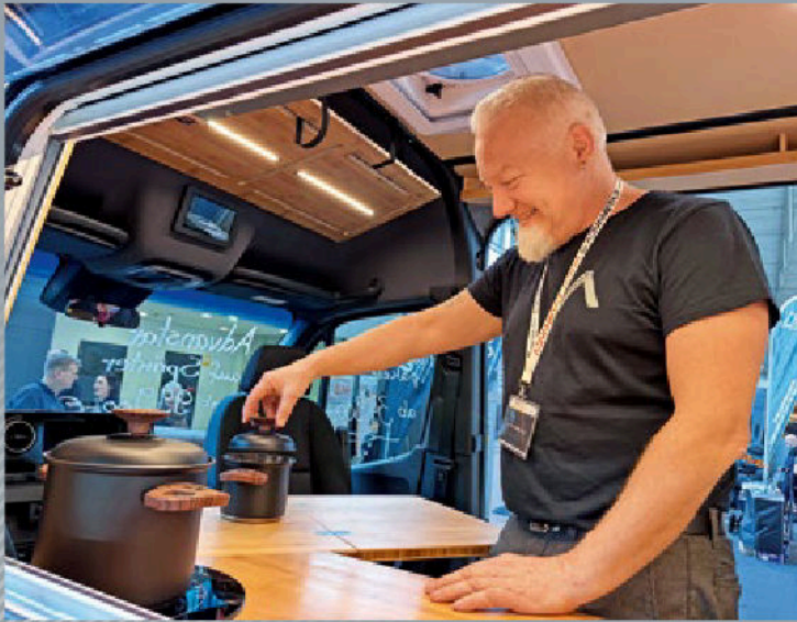
Gasfrei kochen und kühlen: mit 12 Volt, Wechselrichter und hoher Batterie-Kapazität kein Problem. Selbst bei längerem Stehen sorgen Solar und Brennstoffzelle für Nachschub.
