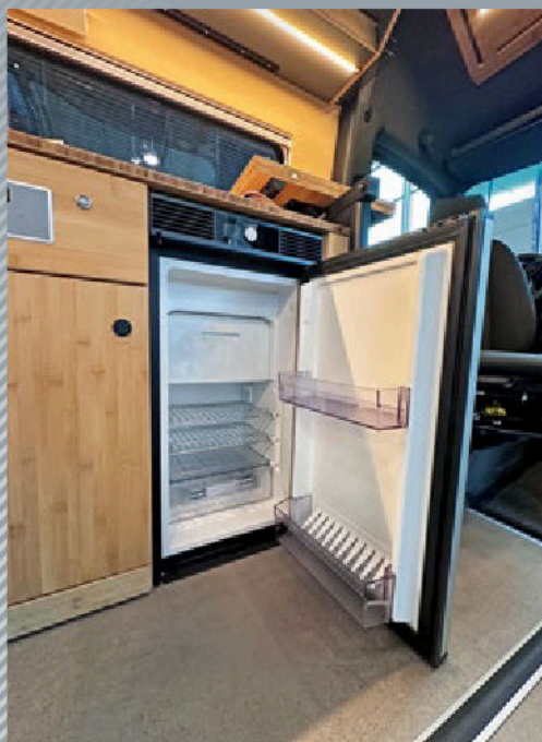
Gasfrei kochen und kühlen: mit 12 Volt, Wechselrichter und hoher Batterie-Kapazität kein Problem. Selbst bei längerem Stehen sorgen Solar und Brennstoffzelle für Nachschub.
